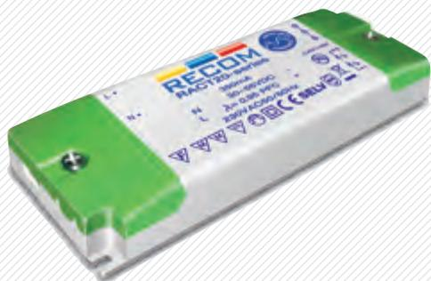
RECOMの低電力AC入力調光機能付きLEDドライバは高い優位性を持っています。RACD20-Dは0~10Vアナログ調光、RACT20はトライアック調光を特徴とした、各20Wのモジュールです。調光機能がないドライバ同様、すべてのモジュールは絶縁型で、UL8750およびEN61374の安全基準に基づく完全な保護がなされています。
